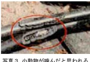
写真 3 小動物が噛んだと思われるケーブルの損傷箇所
